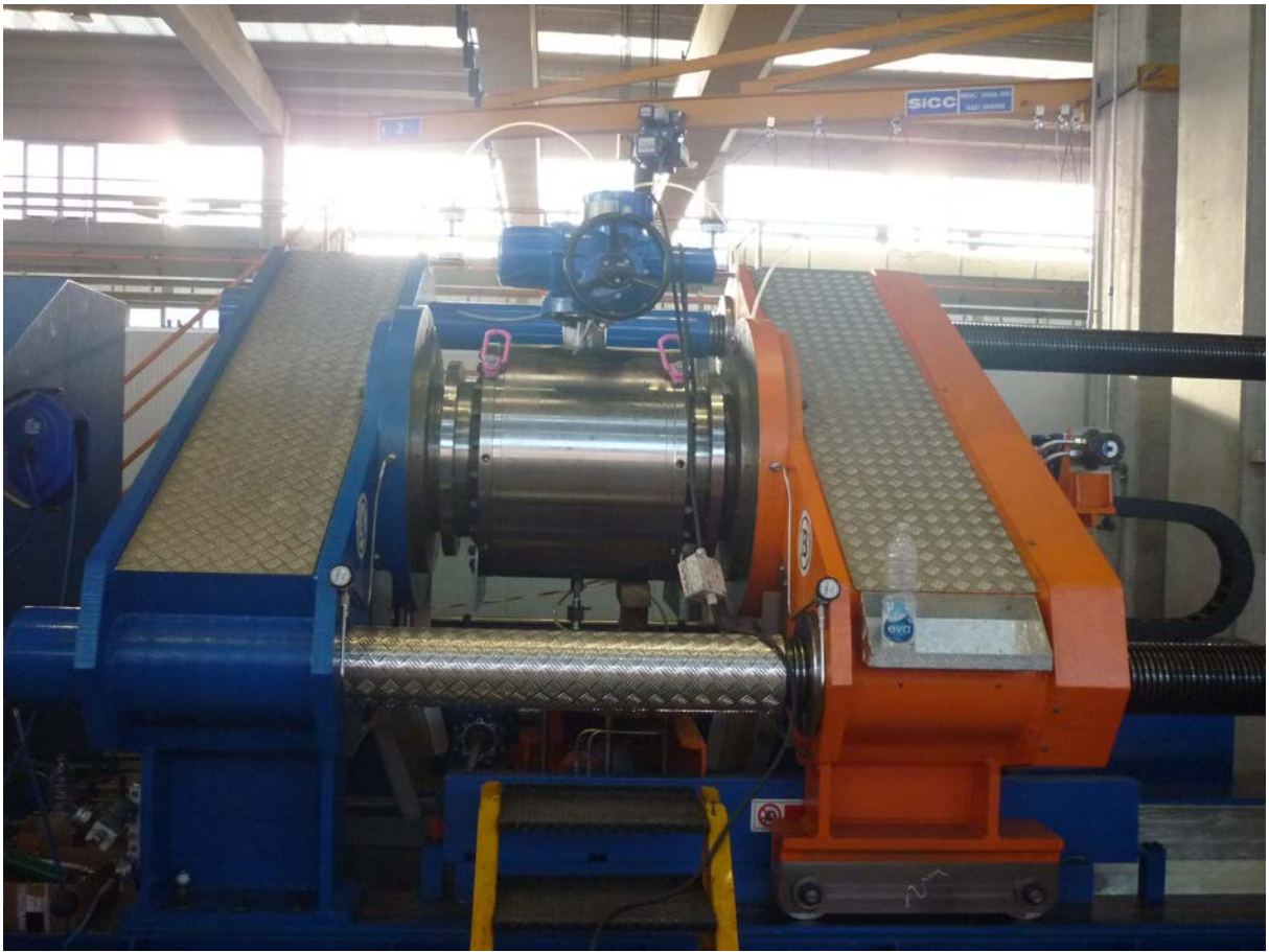
Стенд для испытаний сосудов на прочность и герметичность, Италия
